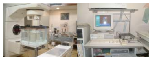
Fig.1 3D 水ファントム CMS 社製 Model3112
