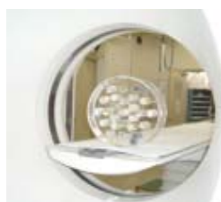
Fig.3 CT 電子密度用ファントム
